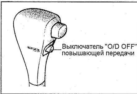
Если кнопка находится в утопленном состоянии и селектор установлен в положение "D", то переключение на повышающую передачу разрешено. В противном случае включение четвертой, повышающей, передачи запрещено. Состояние системы управления в этом случае отражается с помощью индикатора "O/D OFF". В случае разрешения использования повышающей передачи индикатор не горит, а при запрете загорается.
