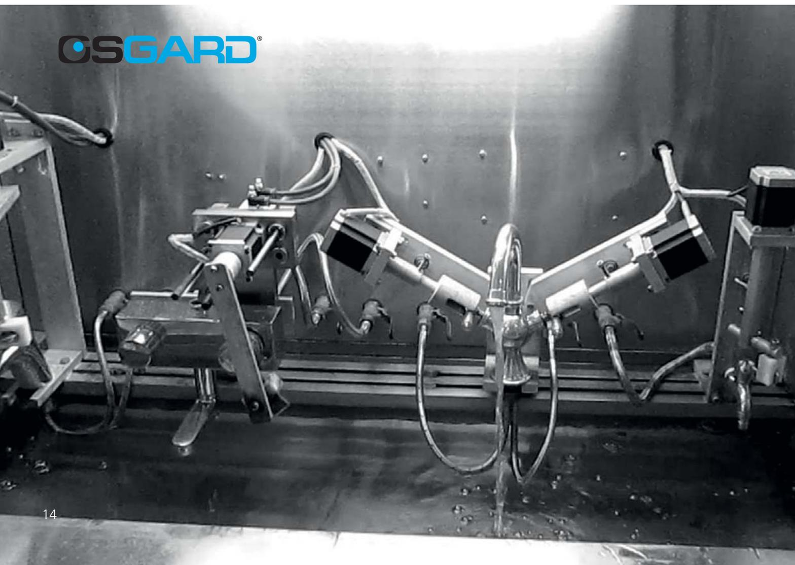
3. Все комплектующие, используемые при производстве смесителей OSGARD, обязательно проходят испытания на компьютерных стендах завода. Отбор образцов для испытаний производится из каждой партии.
