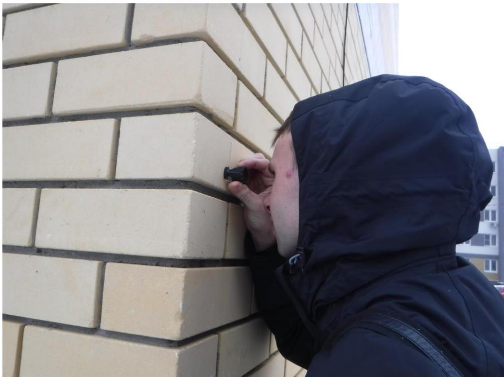
Измерение ширины раскрытия трещины с использованием измерительной лупы ЛИ-3-10
