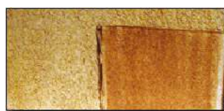
Фрагмент образца с пенополистиролом после 700 циклов испытания перед демонтажем.
