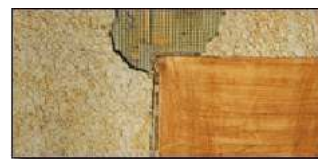
Фрагмент образца с экструдированным пенополистиролом перед демонтажем.
