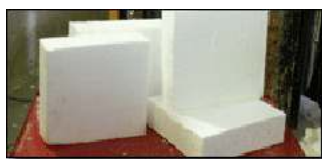
образец блочного пенополистирола (ПСБС С 25)
