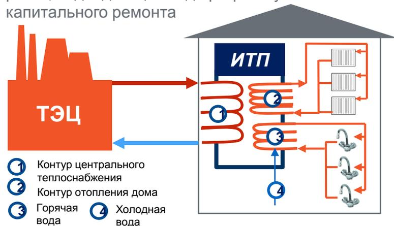
ИТП (индивидуальный тепловой пункт) – комплект оборудования, предназначенный для присоединения систем отопления, горячего водоснабжения и вентиляции здания к тепловой сети, позволяющий изменять температурный и гидравлический режимы теплоносителя, обеспечивать учет и регулирование расхода тепловой энергии и теплоносителя.
